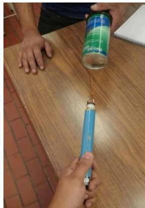
Figura 4.9. Medición de la fuerza de ensamble de distintos productos con un dinamómetro.
