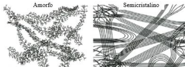
Figura 2.3. Arreglo molecular de la cadena de polímeros.
