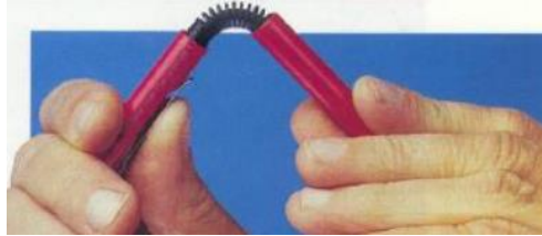
Figura 2.5. Componente de plástico que actúa como resorte [3]
