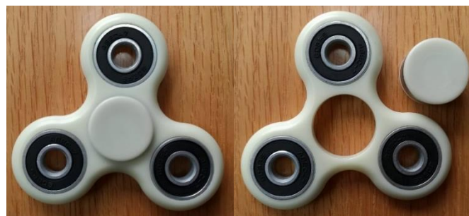
Figura 3.15. Combinación de un buje de plástico con un eje metálico.
