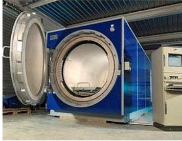
Figura 8. Autoclave para materiales Compuestos
