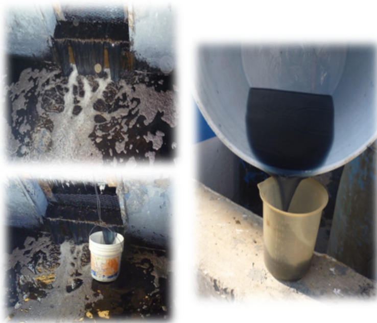
Figura 6.5. Toma de muestras del efluente general
