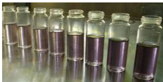
Figura 5.8 Muestras al final de la reacción en función de la concentración del AD2
