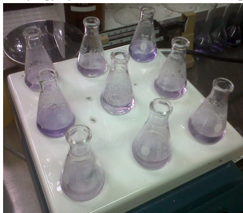
Figura 7.1. Prueba de reactores completamente mezclados utilizados en el proceso de Fenton
