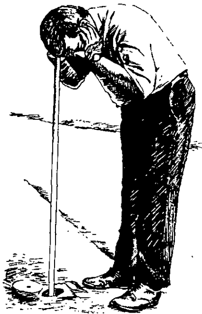
Figura 5.4 Varilla de sondeo
