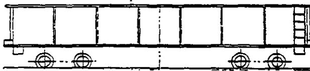
**GONDOLA CUBIERTA.-** Carro especial para transporte de carga con cubierta longitudinal removible, útil para el transporte de rollos de lámina de acero, protegidas de la intemperie.
