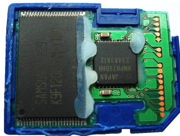
Fig. 2.1. Interior de una tarjeta de memoria.
