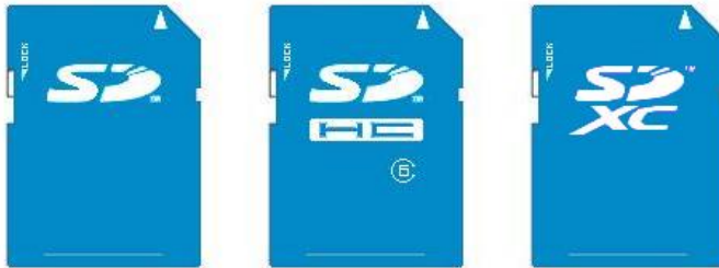
Fig. 2.4. Memorias SD, SDHC y SDXC.
