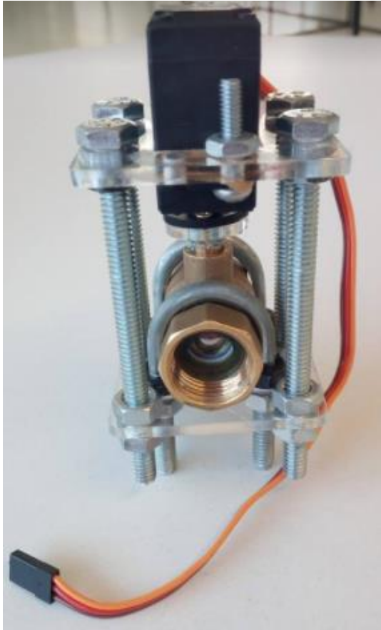
a) Servoválvula final vista frontal.
