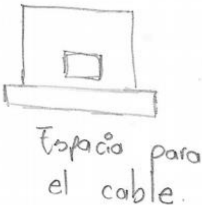
Figura 6.6 Parte trasera del capuchón donde se ve el espacio para el cable.
