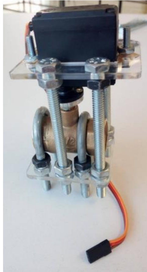
b) Servoválvula final vista lateral.
