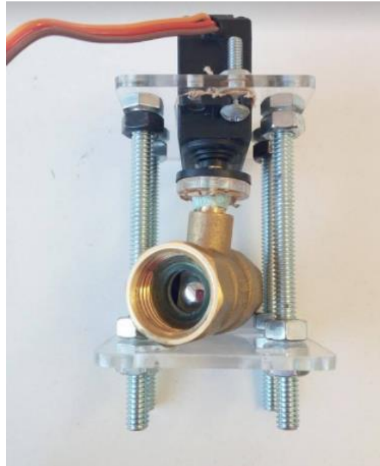
b) Servoválvula después de la torsión.
