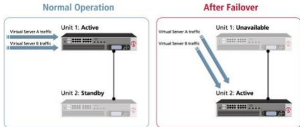
Figura 16. Proceso Failover de un sistema redundante F5. 21
