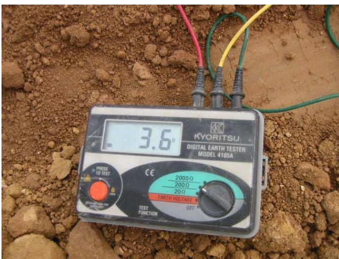
Fig. 7.5.- Equipo de medición Mca. Kyoritsu Mod.4105A mostrando una lectura tomada.
