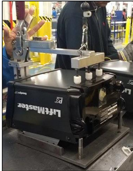
Figura 5 “Aparato para resolver temporalmente el espacio libre en el producto”
