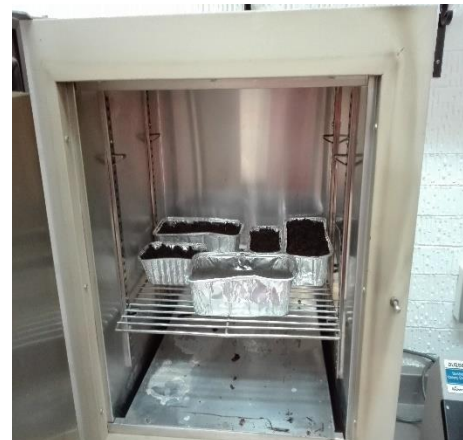
Figura 8.6: Secado de muestras en horno. Fuente: Fotografías tomadas en el sitio.
