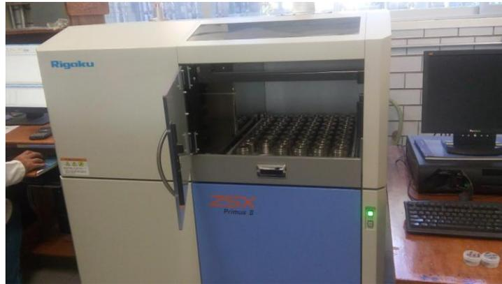
**Fig.71.** Espectrómetro de Fluorescencia Marca: Rigaku Primus II
