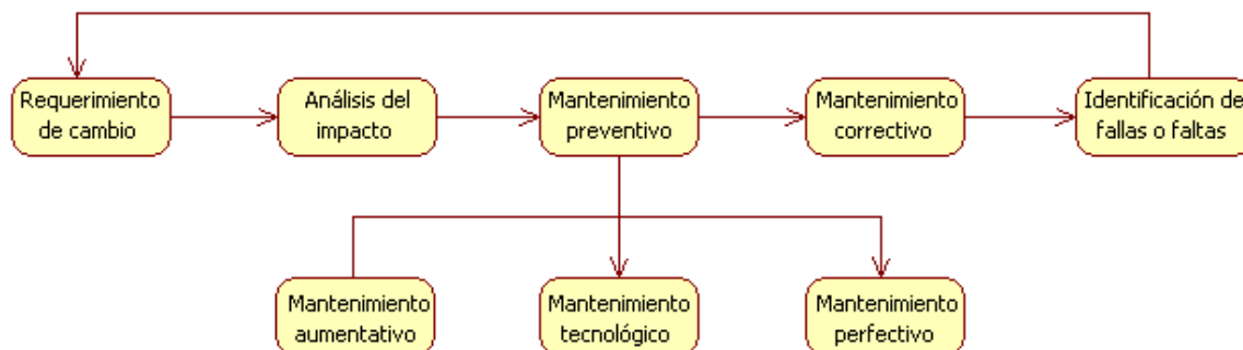
Figura IV.6.14. Flujo de un proceso de mantenimiento
