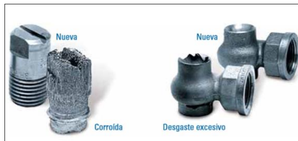
FIGURA 3.29 Boquillas con problemas de corrosión y desgaste (Fuente: Spraying Systems Co).
