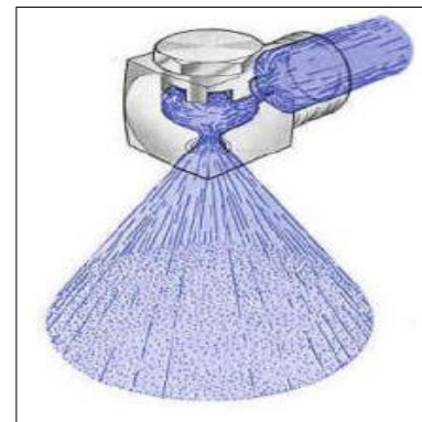
FIGURA 5.7 Esquema de una boquilla con flujo tangencial. (Fuente: Lechler, Inc.)
