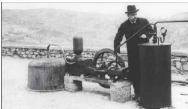
FIGURA 2.5 Primer motor usado para la generación eléctrica a partir de una fuente geotérmica (Fuente: International Geothermal Association, (IGA), http://www.geothermal-energy.org/ ).
