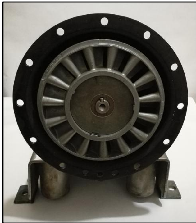
Figura 4.8 Álabes ensamblados a la masa del rotor
