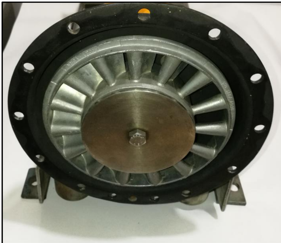
Figura 4.9 Rotor de la turbina armado con giro izquierdo
