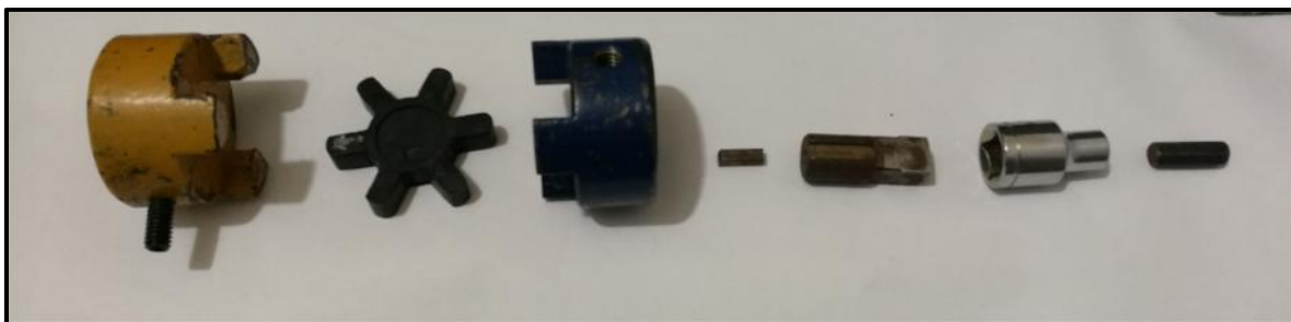
Figura 4.12 Aditamentos para el acoplamiento de quijada modificado
