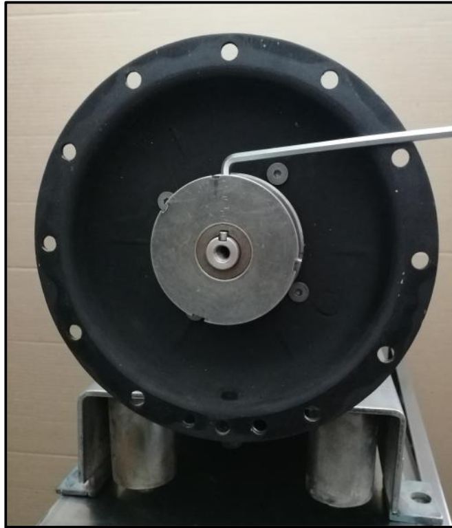
Figura 4.6 Instalación de la masa del rotor con giro izquierdo
