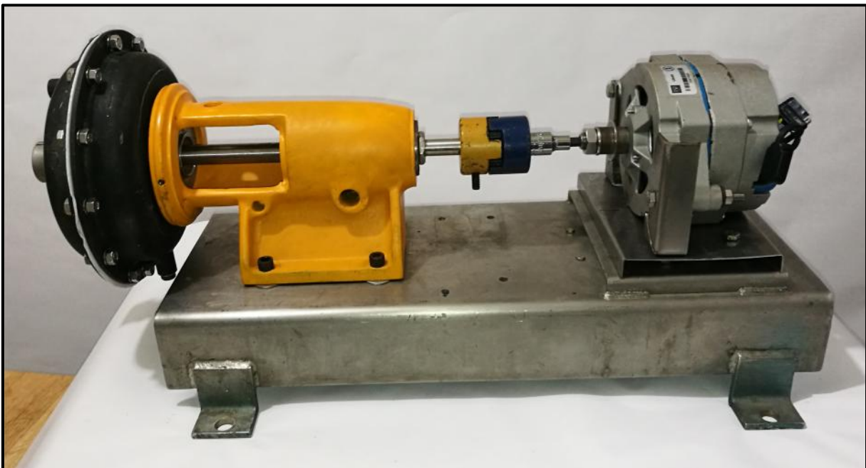
Figura 4.16 Armado final de la turbina
