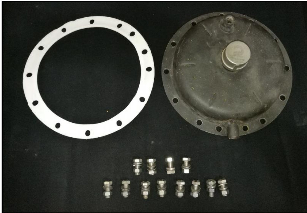
Figura 4.10 Componentes para el sellado del rotor
