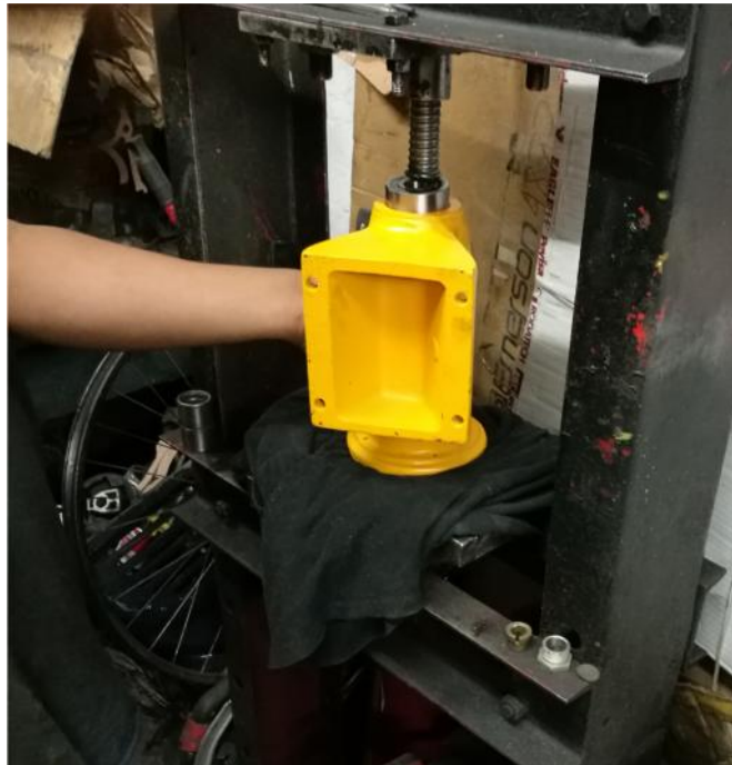
Figura 4.3 Colocación en prensa de balero secundario
