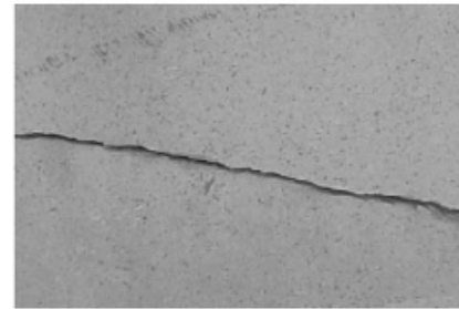
Figura 18.- Representación de una discontinuidad abierta, la cual no contiene ningún tipo de relleno, la abertura puede variar de tamaño va desde 0.25mm-1m o más (Oyanguren 2004).
