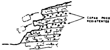
Fig. 13.16.— Evolución de un talud compuesto por capas de diferentes durezas.
