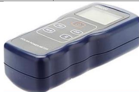
Imagen 4.4 Solarímetro comercial SM206.
