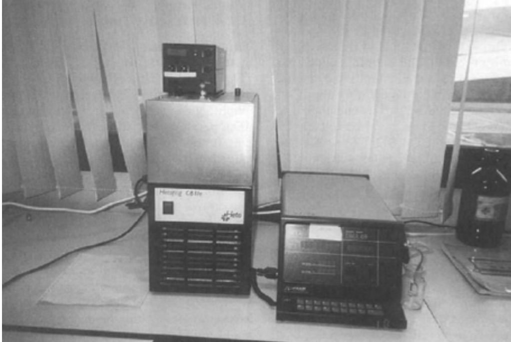
Figura 2.2 Medidor digital usado en la medición de la densidad para fracciones de petróleo y destilados (Riazi M.R., 1980).
