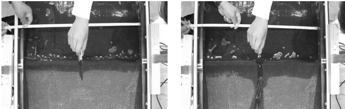
Ilustración 3.5 Llenado del embalse e inicio de falla
