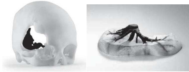
Figura 8 Partes médicas utilizando distintos colores en Manufactura Aditiva. a) Tumor resaltado con ABS más oscuro que el hueso del cráneo b) Modelo de la vascularidad en un órgano humano [5].
