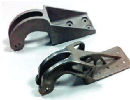
Figura 7 Bisagra de metal utilizada en naves. En la parte de atrás se encuentra el diseño anterior para maquinado, en frente está el rediseño empleando técnicas de optimización topológica, el cual ofrece la misma resistencia mecánica, pero con la mitad del peso [13].
