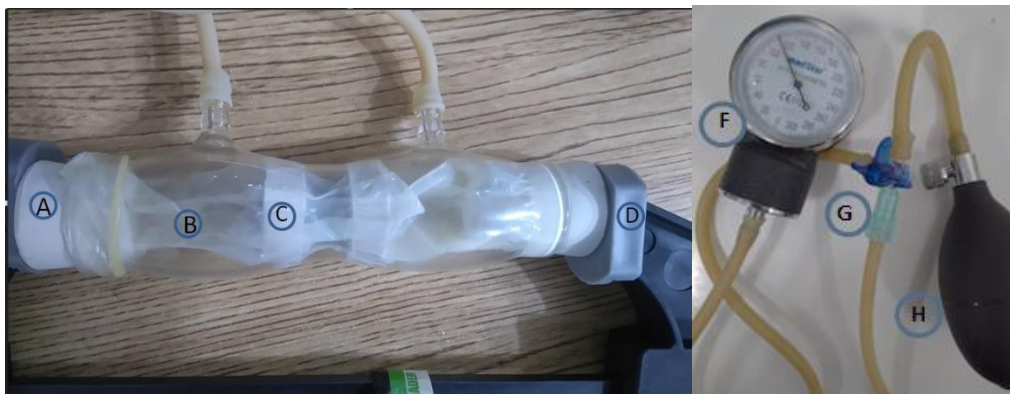
Figura 26. Configuración del prototipo. A) Tapón de caucho; B) condón de látex; C) Anillos de caucho; D) Sargento; F) Manómetro; G) Válvula de tres vías; H) Pera de goma.
