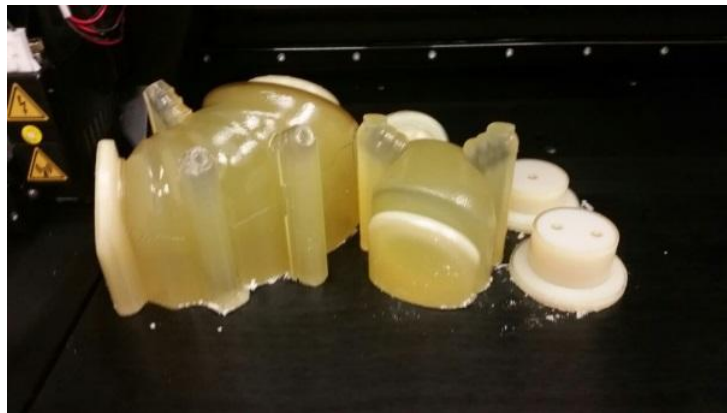
Figura 49. Construcción del estómago por manufactura aditiva (Objet500 Connex, Stratasys).
