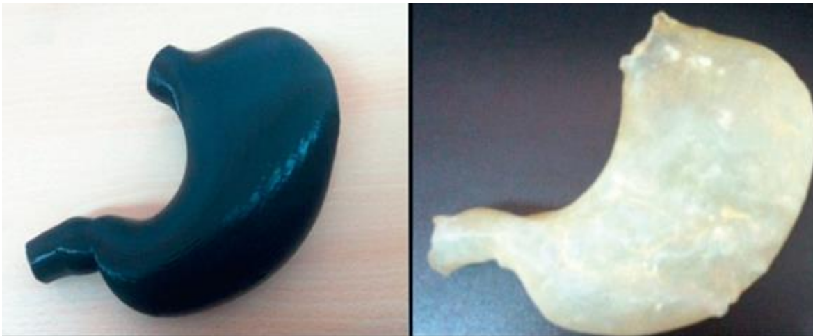
Figura 13. Modelo IMGS a) Molde del estómago IMGS realizado por manufactura aditiva (lado izquierdo) b) estómago de látex (lado derecho) [11].
