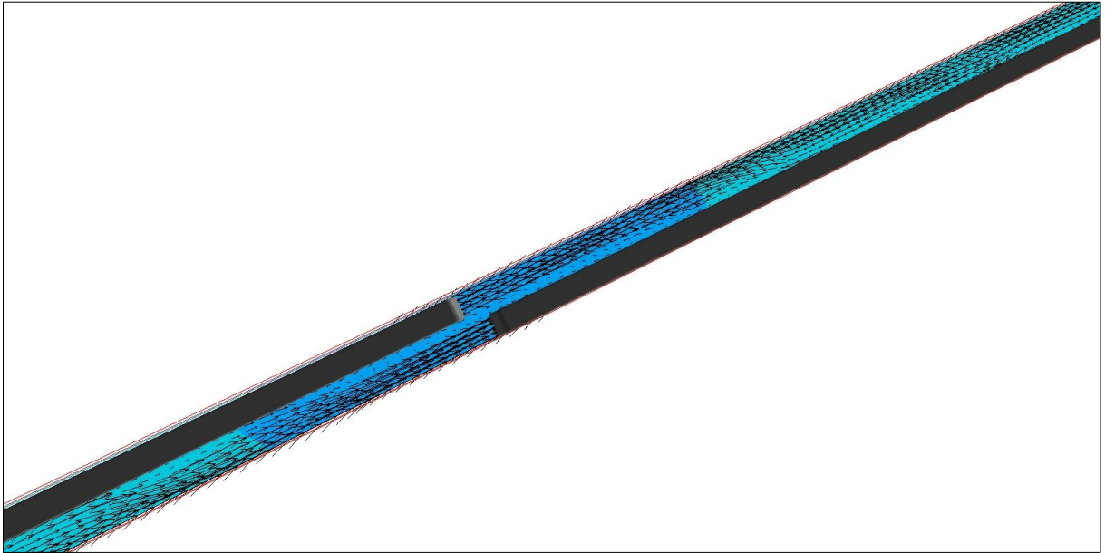
Figura 4.14. - Contorno y vectores de presión de los trenes a la mitad del túnel.
