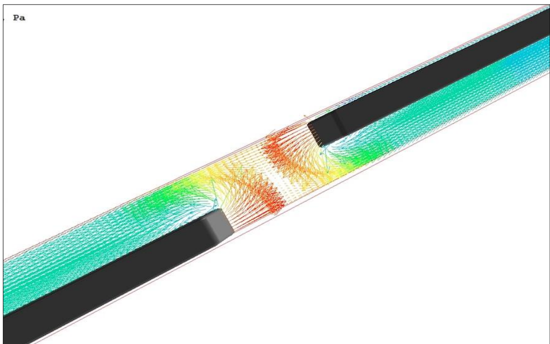
Figura 4.13. - Líneas de presión cuando dos trenes se encuentran dentro del túnel.
