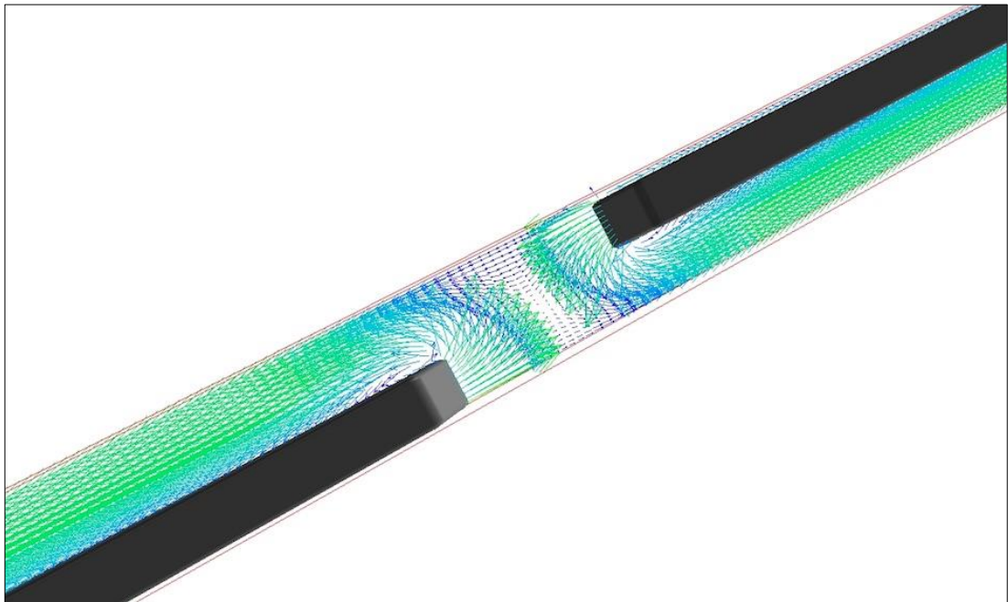
Figura 4.12. - Líneas de velocidad, instantes antes de que los trenes se encuentren dentro del túnel.
