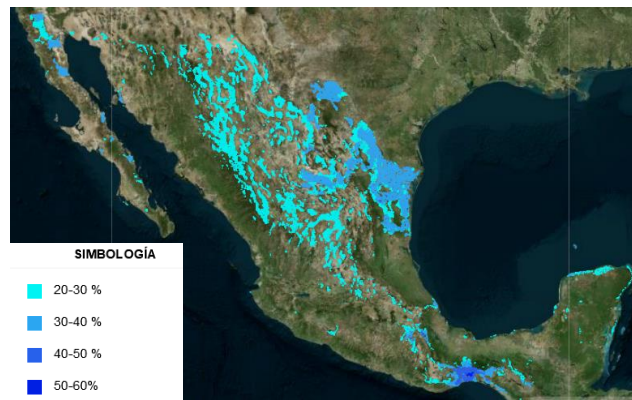
Figura 2. 18. Zonas disponibles con alto potencial de aprovechamiento de energía eólica.
