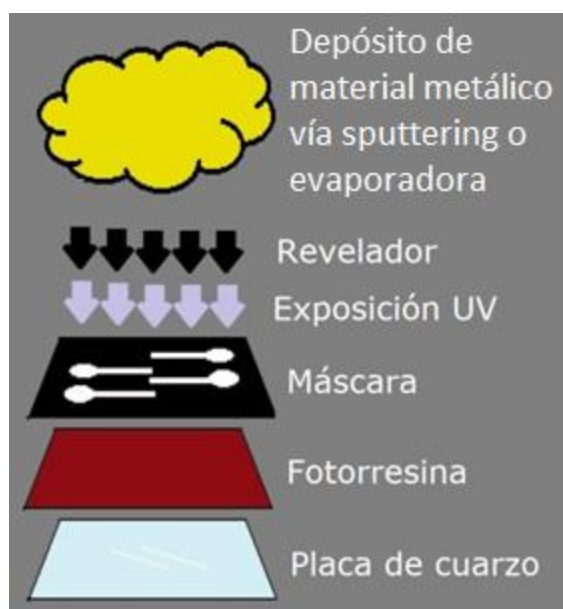
Figura 8.15. Esquema del proceso de fotolitografía mediante la técnica “ lift off ”.
