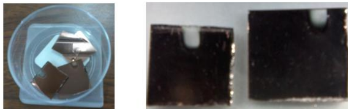
Figura 8.12. Pedazos de vidrio con una película delgada de cobre depositada.
