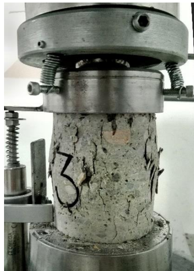
Figura 13. Modo de falla de una probeta de concreto lanzado reforzado con fibras ensayada con la técnica de deformación controlada.
