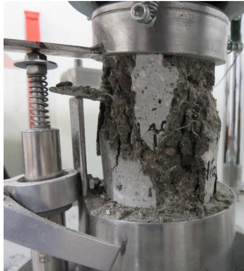
Figura 11. Modo de falla de una probeta de concreto lanzado reforzado con fibras ensayada con la técnica de carga controlada.
