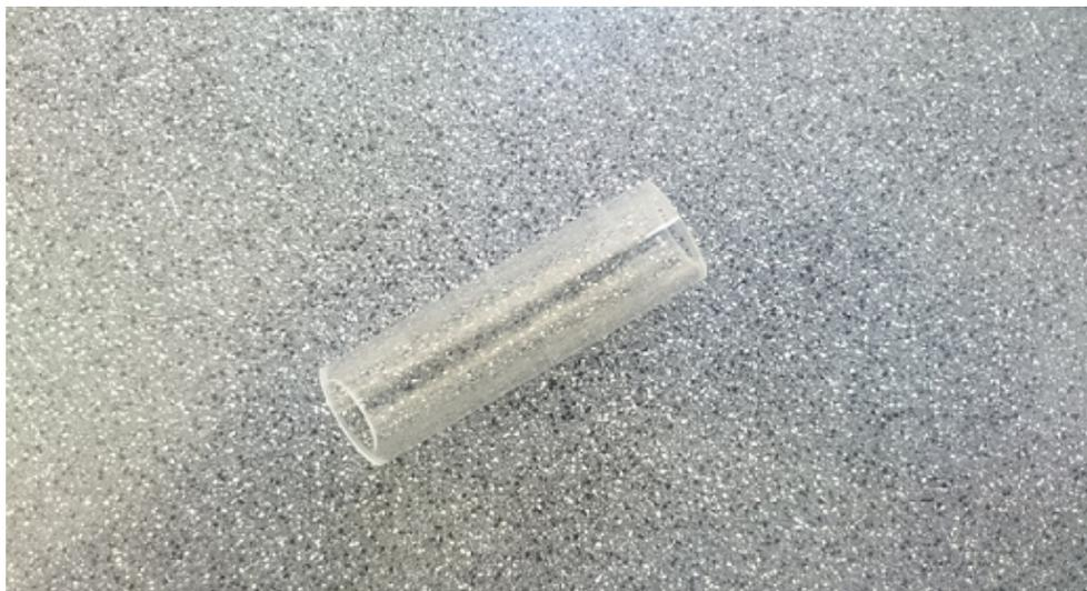
Figura 7.13: Celda cilíndrica de borosilicato.
