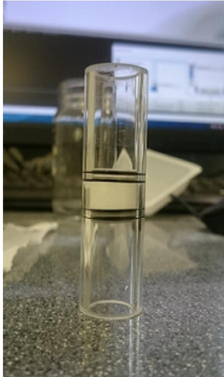
Figura 7.17: Calcita empacada dentro de la celda.
