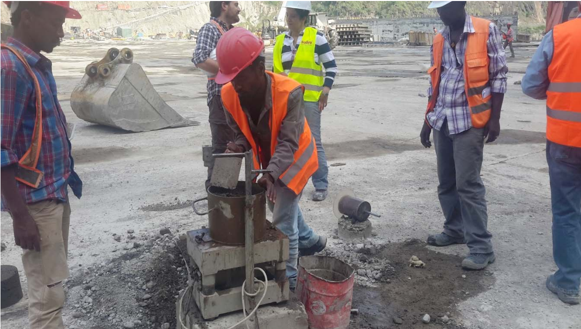
Figura 4- 40 Medición de tiempo VeBe mediante mesa de vibrado
