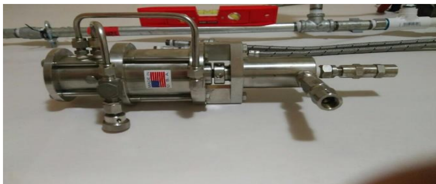
Figura 4.3.5. Bomba de inyección utilizada
