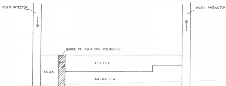
FIG.A.- INYECCION DE AGUA CON POLIMEROS<sup>(9)</sup>
