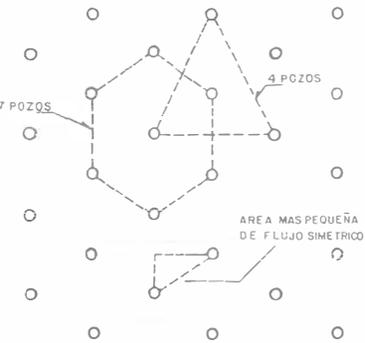
FIG. 7 REPRESENTACION DIAGRAMATICA DE UN ARREGLO DE 7 Y 4 POZOS<sup>(12)</sup>
