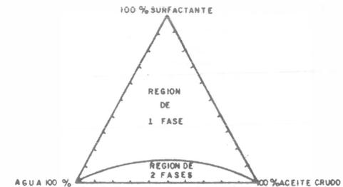
FIG. 4 - MUESTRA EL TRIANGULO QUE TIENE EN SUS VERTICES A LOS 3 COMPONENTES PRINCIPALES DE LOS MISCELARES. (2)
