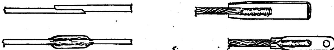
FIG. 7.- TIPOS DE PIEZAS UNIDAS POR SOLDADURA FRÍA.
