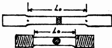
Probetas para ensayo de tracción.
