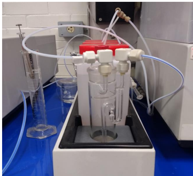
FIGURA 12 SISTEMA DE ANÁLISIS PARA MEDICIÓN DE CARBONATO EN EL EQUIPO DE HiPerTOC.
