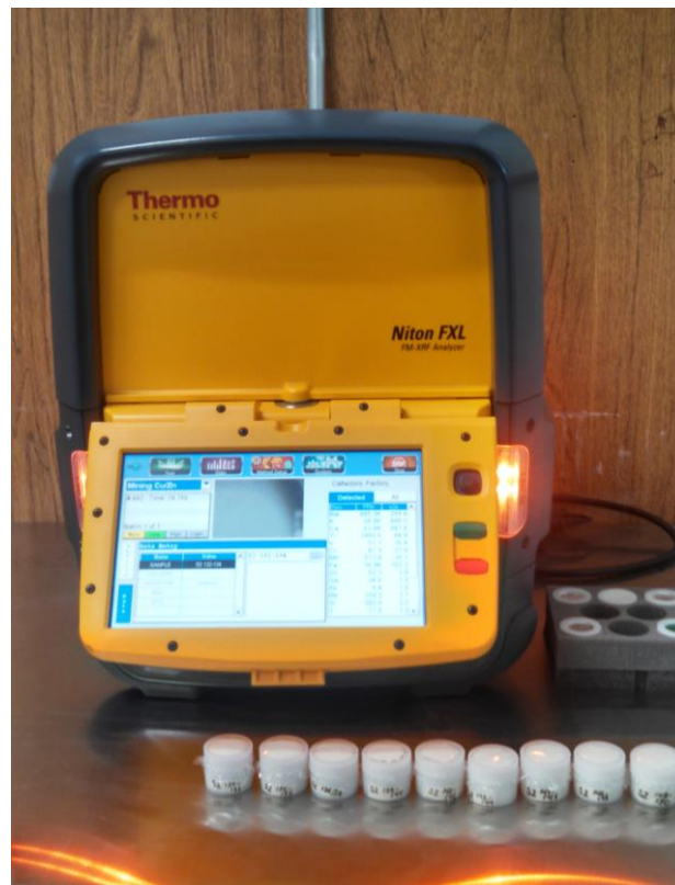
FIGURA 8 EQUIPO DE FRX DE MARCA THERMO SCIENTIFIC Y MODELO NITON FXL 950 UTILIZADO PARA LA ANÁLISIS DE ELEMENTOS MAYORES Y TRAZAS DE LAS MUESTRAS DE LA CUENCA DE SANDIA.
