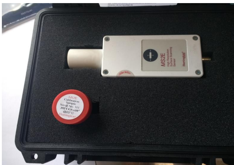
FIGURA 9 FOTOGRAFÍA DEL SENSOR BARTINGTON MS2E Y ESTÁNDAR UTILIZADOS PARA LA MEDICIÓN DE SUSCEPTIBILIDAD MAGNÉTICA DE LAS MUESTRAS DE CUENCA SANDIA.
