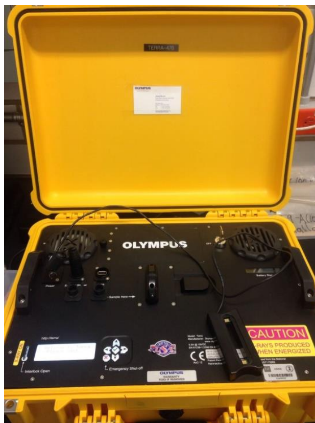
FIGURA 6 DIFRACTÓMETRO PORTÁTIL MARCA OLYMPUS MODELO TERRA 476 UTILIZADO PARA LA IDENTIFICACIÓN DE MINERALES CARBONATADOS Y EVAPORITICOS EN LOS SEDIMENTOS DE LA CUENCA DE SANDIA.
