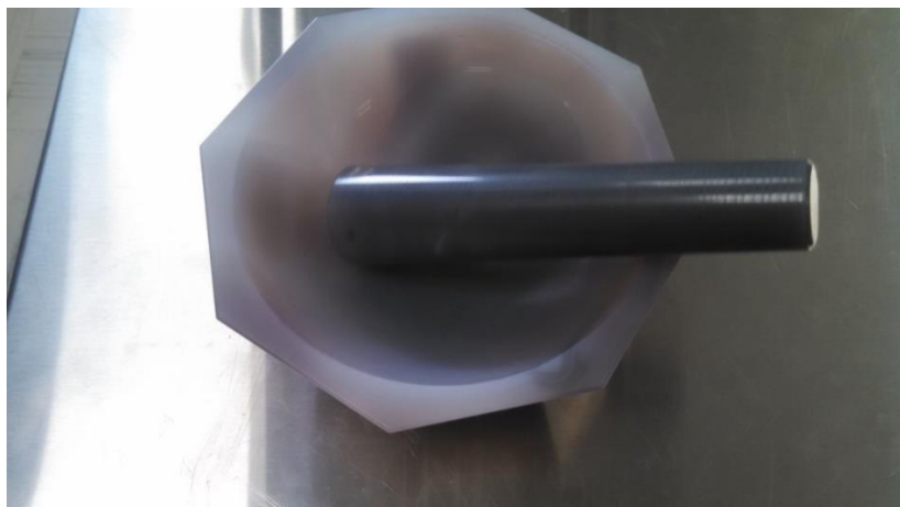
FIGURA 5 MORTERO DE ÁGATA UTILIZADO PARA MOLER Y HOMOGENIZAR LAS MUESTRA DE SEDIMENTOS COLECTADO DE LA CUENCA DE SANDIA.
