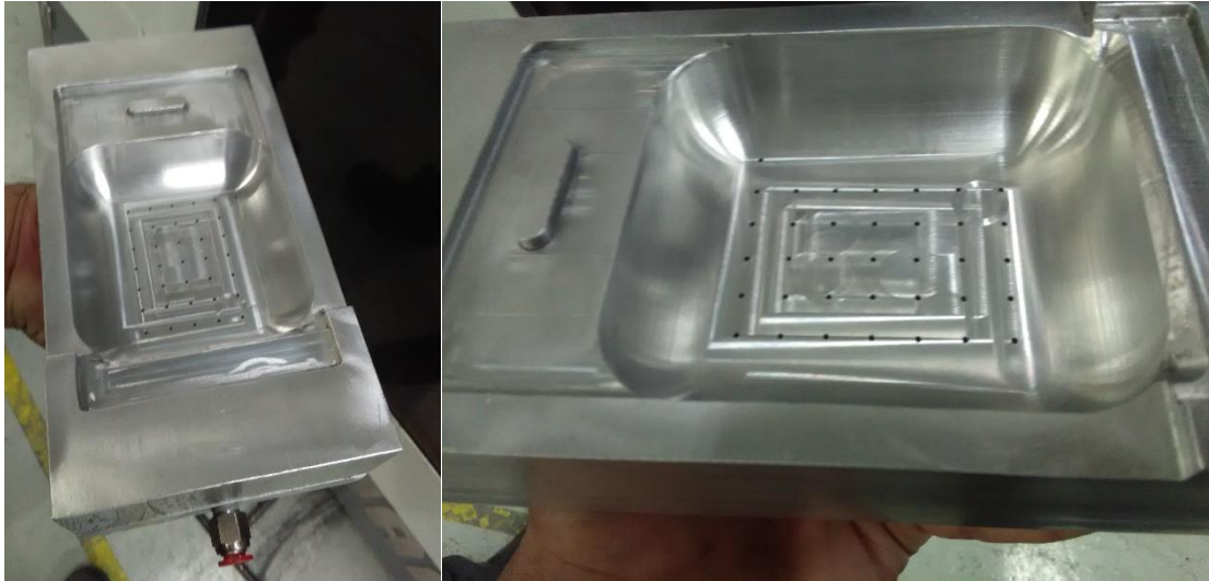
Fig. 7.19 Molde maquinado en aluminio, se manufacturo utilizando una fresadora CNC.
