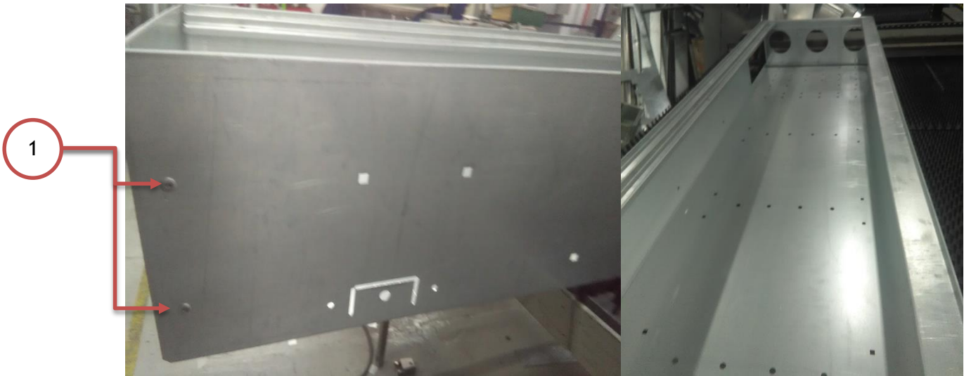
Fig. 7.3 (1) La parte remachada del tablero corresponde a la sujeción del techo y del piso que unen al gabinete como si fuese una sola pieza.
