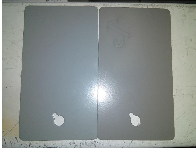
Fig. 7.1 Recubrimiento anticorrosivo por medio de pintura electrostática, en la imagen se aprecia dos tonalidades de ANSI 61 de izquierda a derecha ANSI 61-30748 y ANSI 61-1085 respectivamente.
