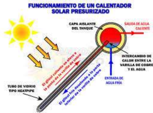
Ilustración 9. Funcionamiento calentador solar presurizado [9]
