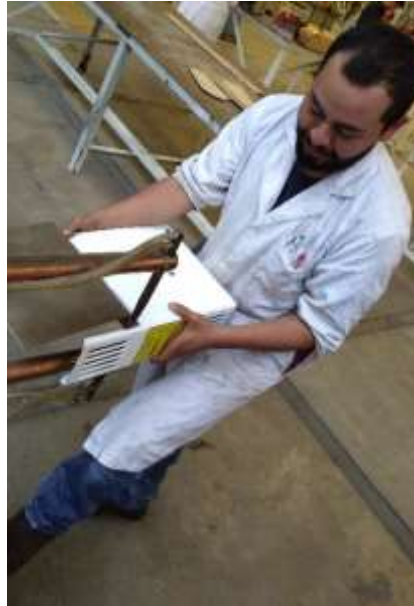
Ilustración 39. Proceso de soldadura de punto [39]
