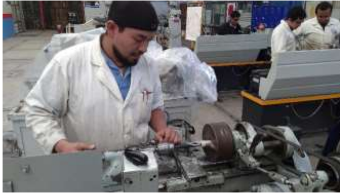
Ilustración 37. Proceso de barrenado de las piezas en torno [37].
