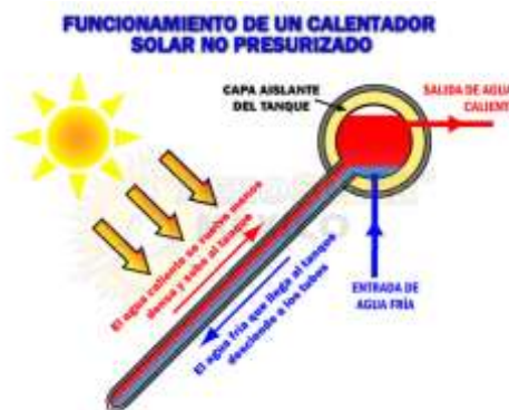
Ilustración 7 Funcionamiento de un calentador solar no presurizado. [7]
