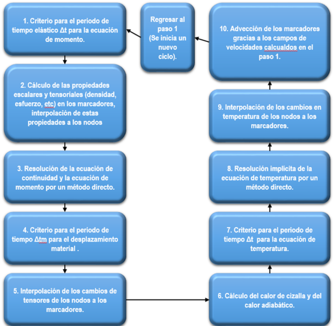
Figura 5.1: Esquema general de la posible estructura para un código termo-mecánico visco-elástico-plástico 2D. Se utilizan diferencias finitas y la técnica de marcador en celda para resolver las ecuaciones de movimiento, continuidad y temperatura. Modificada de Gerya and Yuen (2007)
