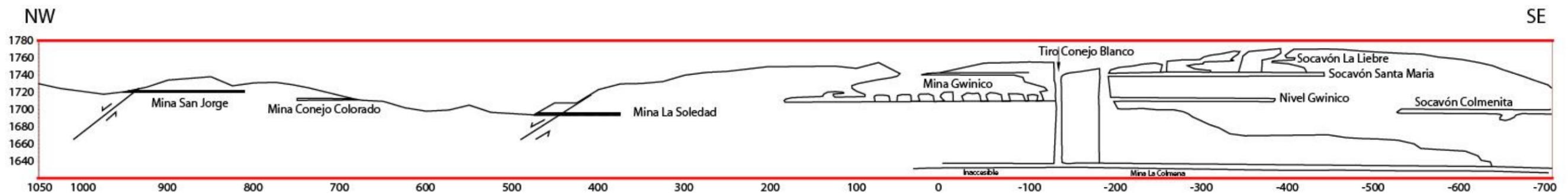
Figura 15. Sección que muestra la distribución de las obras mineras en el área de estudio.
