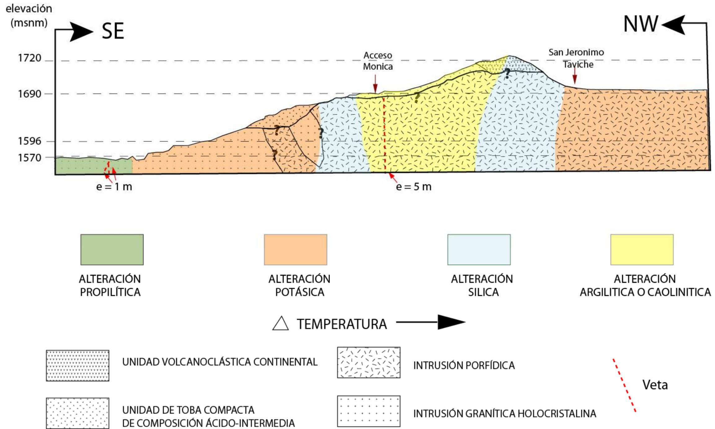
Figura 28: Sección transversal que muestra la distribución de las alteraciones hidrotermales en el área de estudio.
