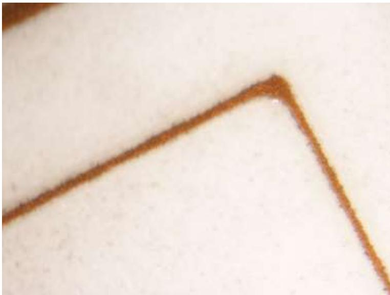
*Figura 134. Marca de alineación de 40 micras*
