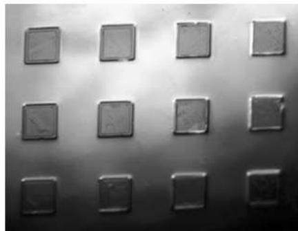
Figura 8. Islas de SiO<sub>2</sub>. Imagen tomada de [6]
