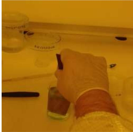
*Figura 119. Ataque del inductor*
