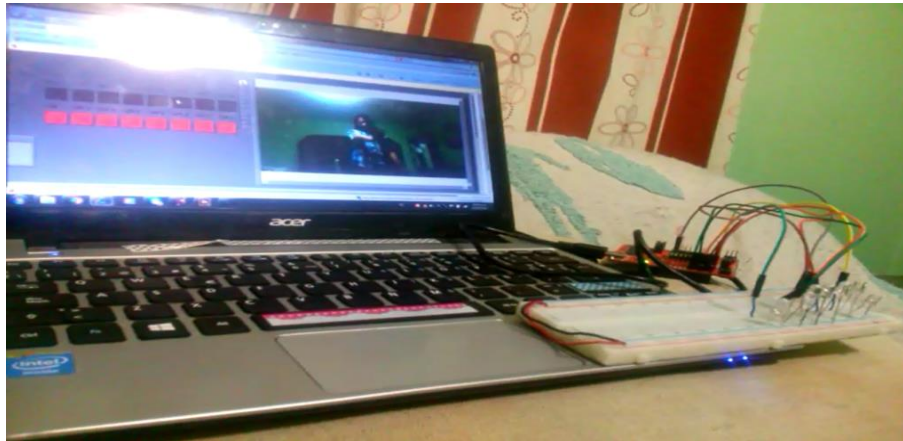
Ilustración 78 Fotografía de primeras pruebas con PC, Kinect y el microcontrolador msp430g2553 leds desactivados.
