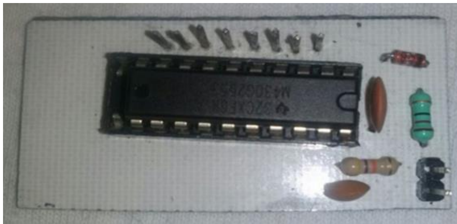
Ilustración 51 Circuito final encargado de la alarma SMS
