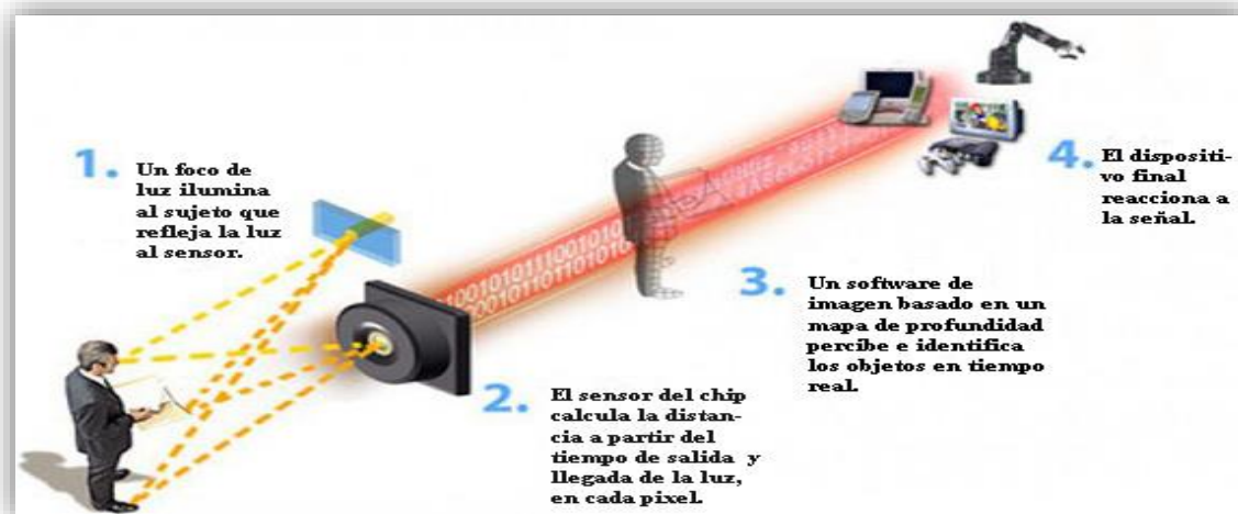
Ilustración 5 Diagrama de funcionamiento del Kinect [17].
