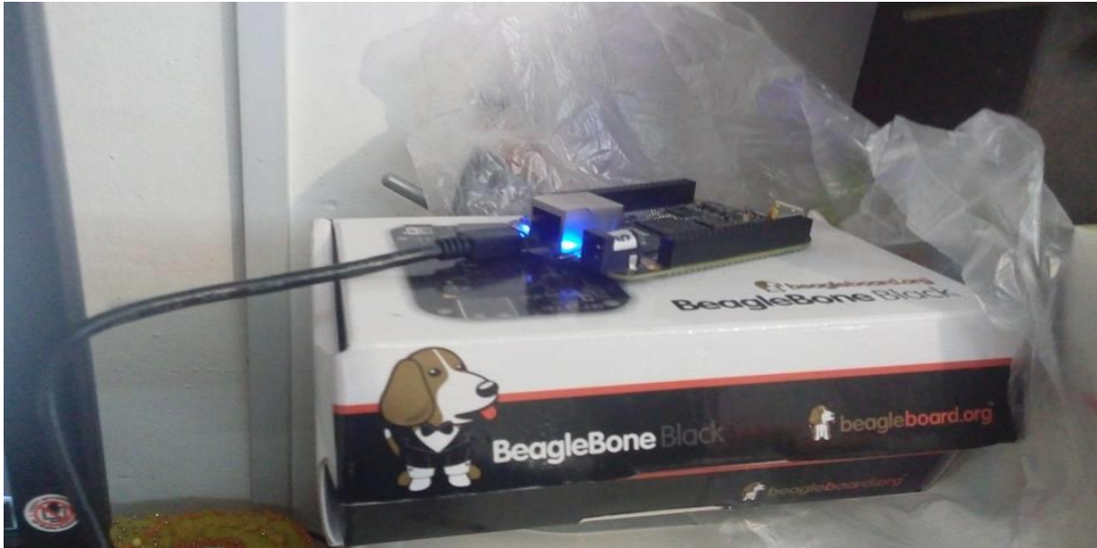
Ilustración 58 Fotografía que muestra la forma física de la Beagle Bone Black.
