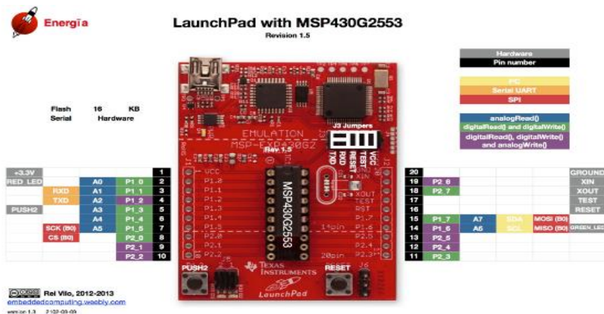
Ilustración 21 Diagrama de la plataforma con el microcontrolador msp430g2553 [24].
