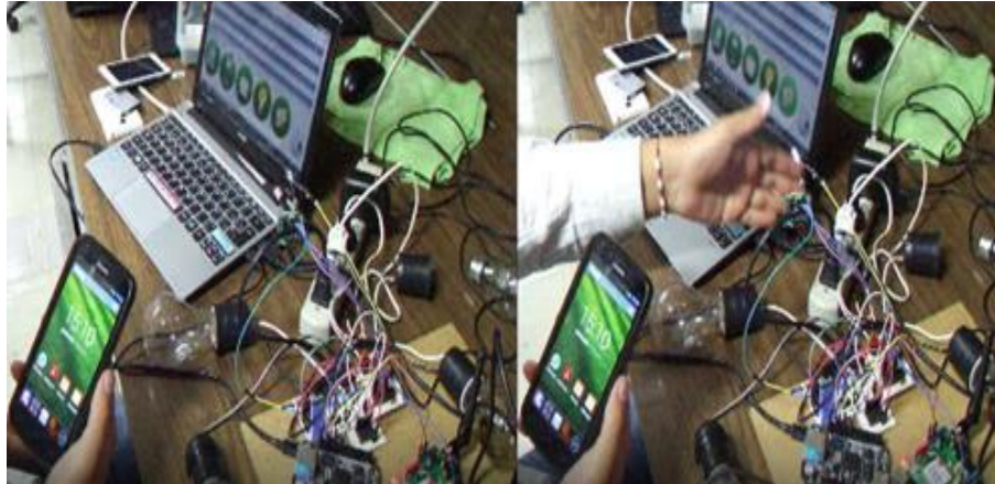
Ilustración 84 Pruebas integrales con la alarma SMS una vez activada y detectando movimiento humano.
