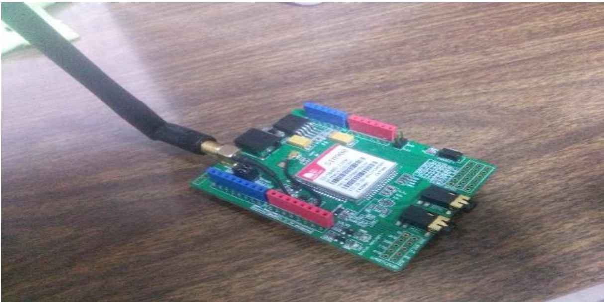
Ilustración 36 Fotografía que muestra el aspecto físico del módulo SIM900.
