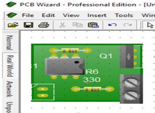
Ilustración 48 Diseño del PCB de los circuitos ON/OFF en CA sistema.
