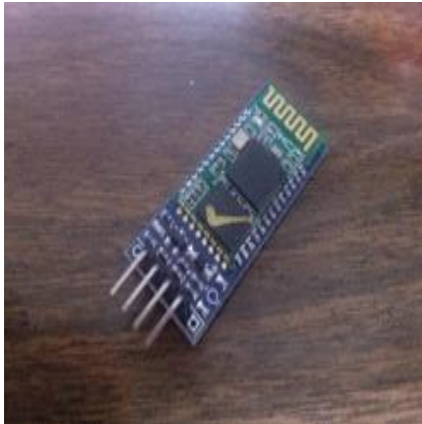
Ilustración 27 Modulo Bluetooth HC-05 con configuración Maestro/Esclavo.
