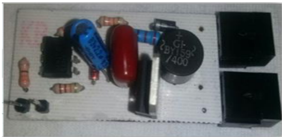
Ilustración 47 Circuito final Dimmer en CA.
