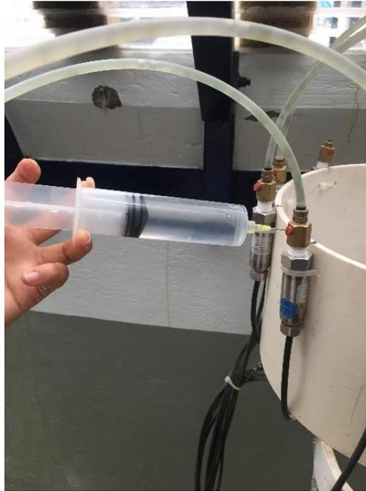
Figura 57. Proceso de purgado de las mangueras de conexión.
