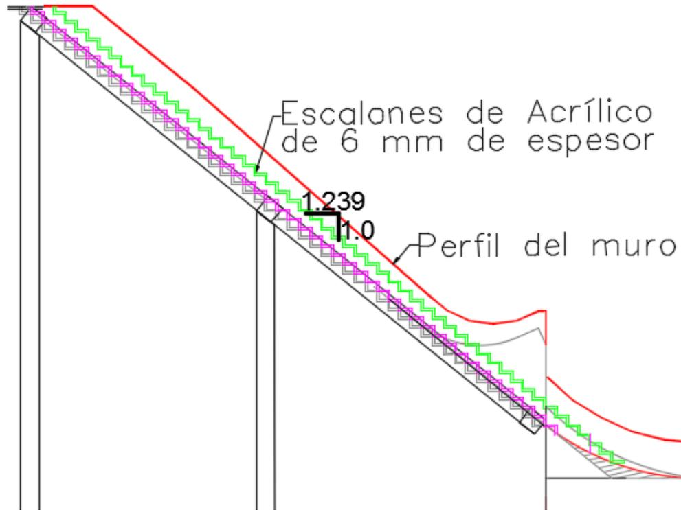
Figura 38. Esquema de la rápida escalonada.
