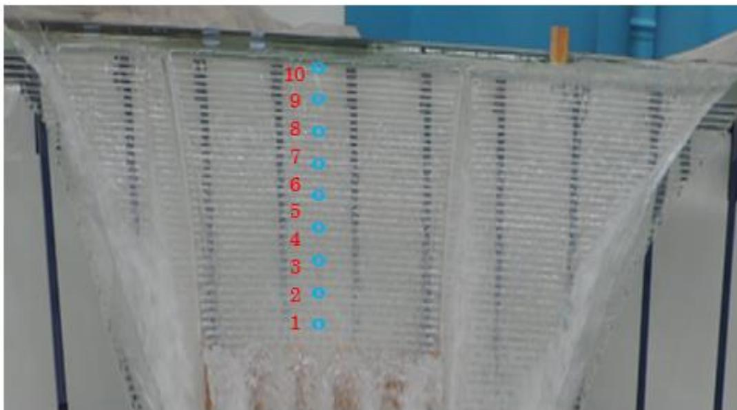
Figura 66. Distribución de piezómetros.
