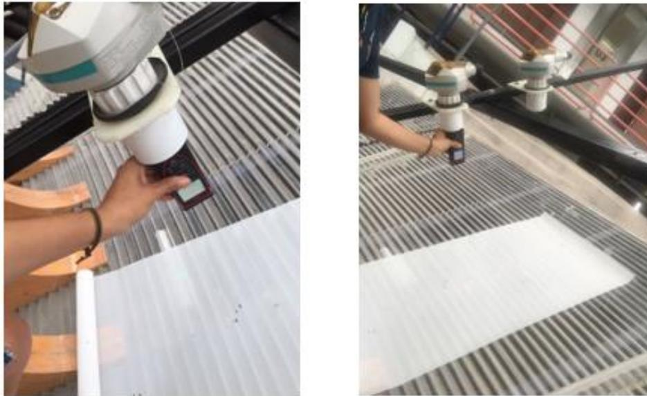
Figura 53. Definición de la distancia entre las narices de la escalonada y el sensor.
