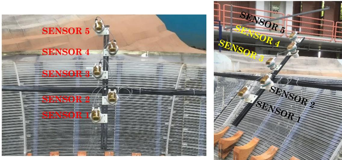
Figura 43. Posicionamiento de los transmisores de nivel de dos hilos.
