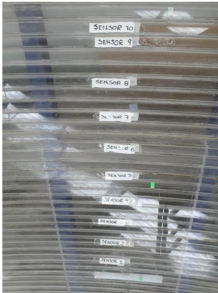
Figura 52. Posicionamiento ubicación de los sensores de presión.
