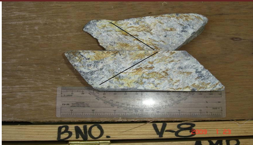
Fotografía II.19 - Detalle de una muestra de núcleo del Bno. S8 (perforado verticalmente), que contiene un plano de falla con estrías inclinadas que indican un movimiento con componente lateral (líneas negras).
