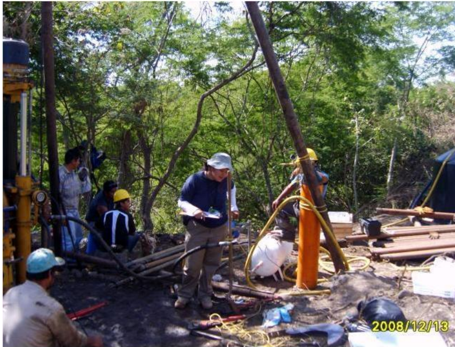
Fotografía III.1 – Equipo para realizar pruebas de permeabilidad.
