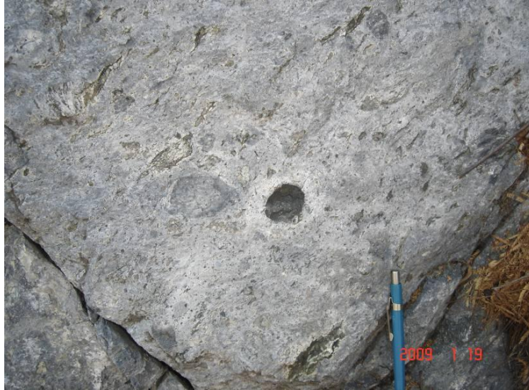
Fotografía II.6 - Detalle de la brecha tobacea andesítica con sus fragmentos de roca y algunas vesículas rellenas por minerales metálicos.
