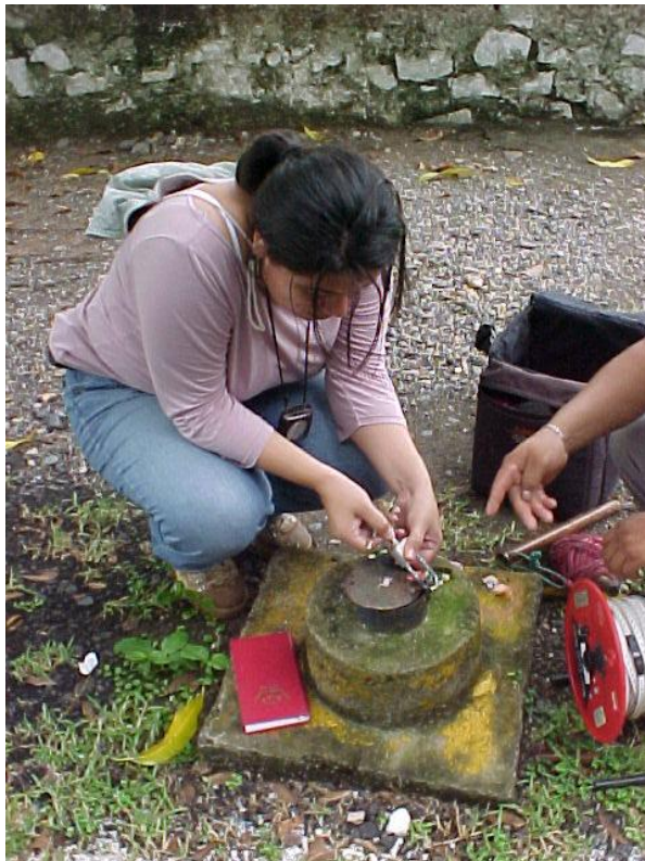
A-4 – Realización de pruebas de permeabilidad
