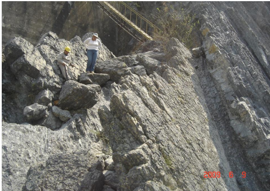
Fotografía II.20 - Panorámica de la secuencia volcanosedimentaria tobácea donde se tienen fallas paralelas a la seudostratificación (movimiento capa-capa), con zonas de cizalla de hasta 10 cm de espesor. Afloramiento ubicado en la margen izquierda de la salida del Vertedor.
