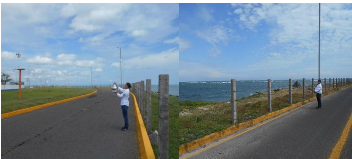
Figura 4.3: Toma de muestra de aire ambiente, viento arriba.
