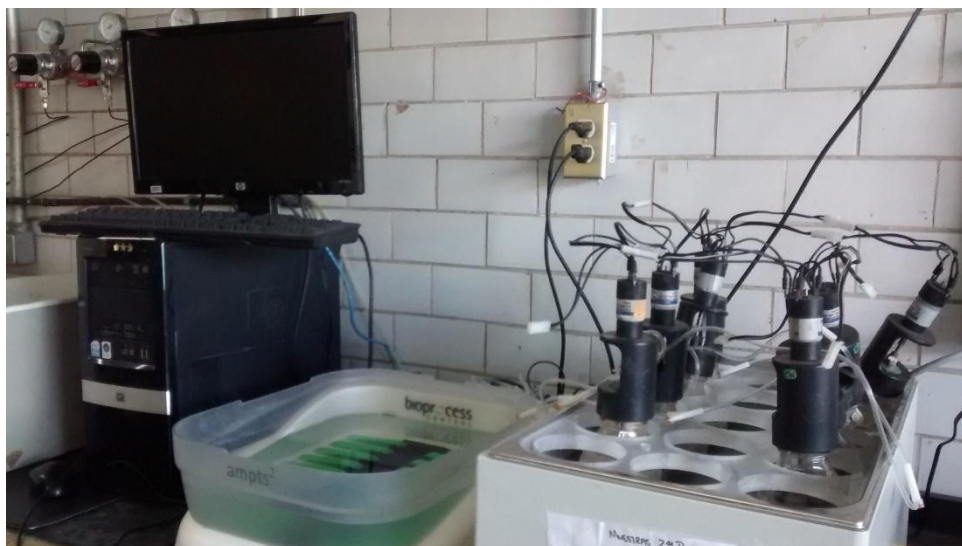
Figura 4.2. Equipo para la realización de las CDA en reactores semicontinuos. De derecha a izquierda se observan: reactores semicontinuos conectados al contador digital de biogás y éste; a su vez, está conectado a una PC para el despliegue y procesamiento de los datos
