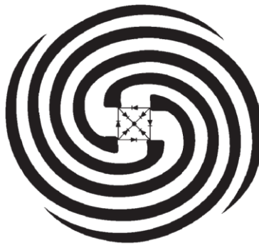
Figura 2.2 Elemento de 4 brazos espirales con conmutación de diodos al centro, propuesta por Phelan[2]
