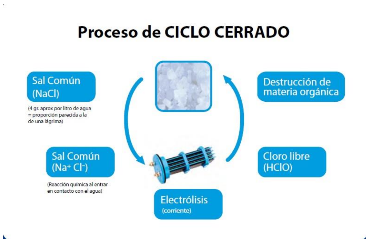
Figura 14 “Sistema de cloración”
