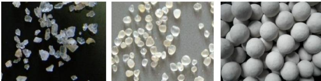
Figura 4.7 Arena, arena recubierta con resina y cerámicos, respectivamente. 86
