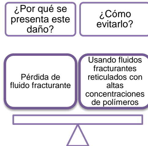
Figura 4.11 Razones del daño en la cara de la fractura.
