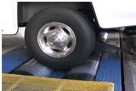
Figura 2.6 Funcionamiento de rodillos [13]
