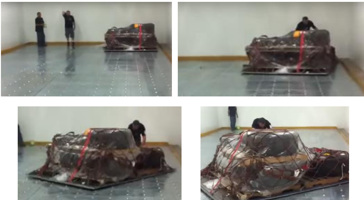
Figura 3.9 Ilustraciones similitud de empuje de lámina de nylamind sobre los Racks dinámicos.
