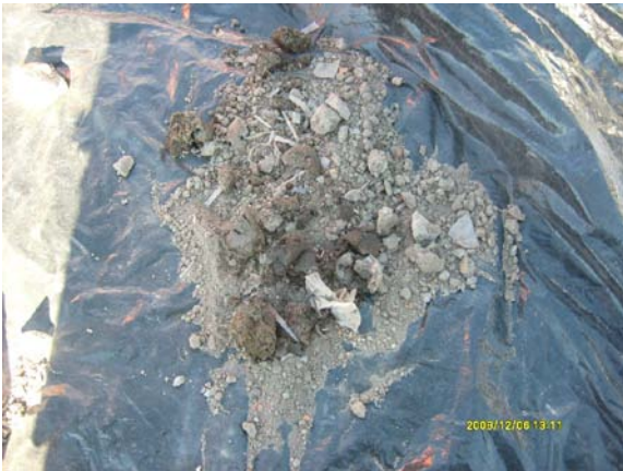
Fotografía 23. Muestreo de suelo en el sondeo SDN-4, se observa residuos plásticos.
