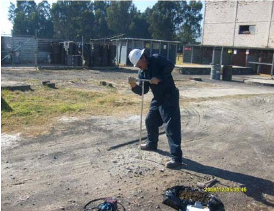
Fotografía 19. Muestreo de suelo en el sondeo STD-8
