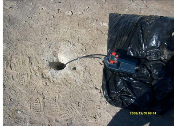
Fotografía 20. Medición de vapores orgánicos (ppm) y explosividad
