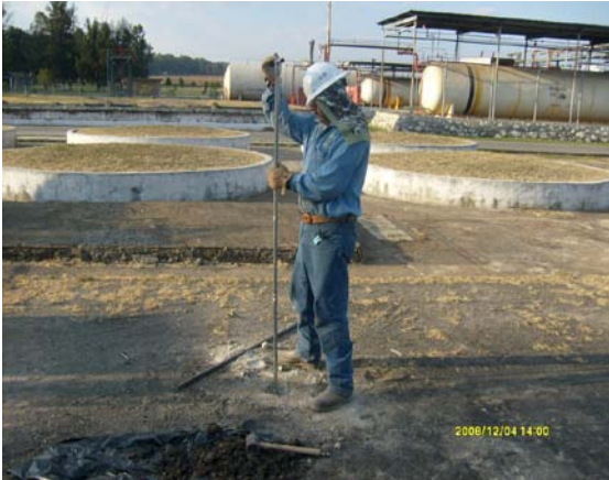
Fotografía 13. Muestreo de suelo en el sondeo SB-14
