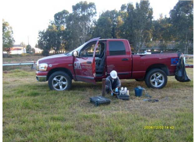
Fotografía 38. Muestreo de agua en el pozo PMZ-10
