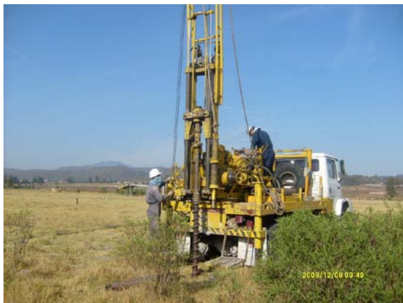
Fotografía 29. Muestreo de suelo en el sondeo SNE-1.
