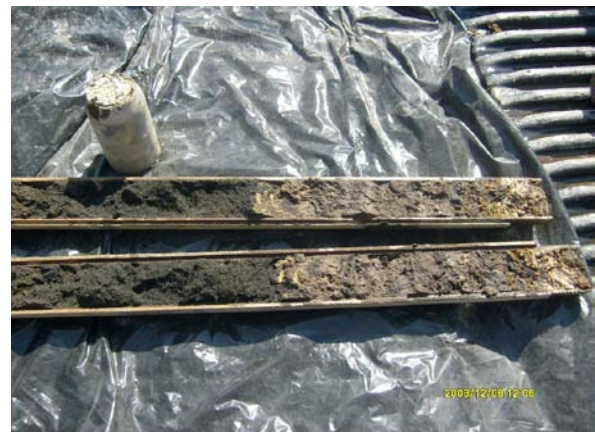
Fotografía 30. Muestreo de suelo en el sondeo SNE-3.
