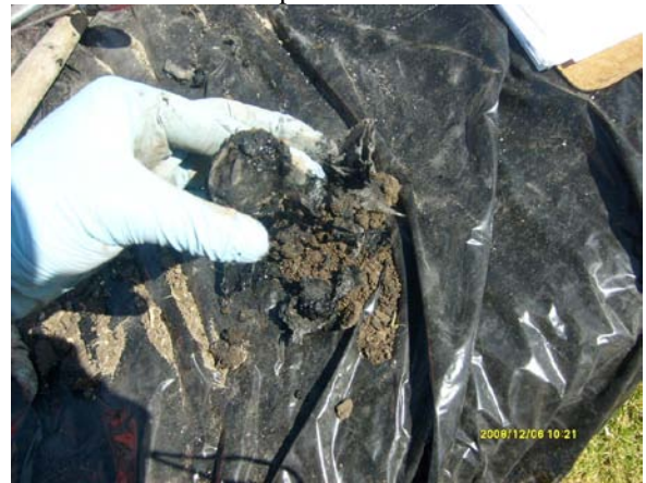
Fotografía 22. Muestreo de suelo en el sondeo SDN-3, se observa residuos plásticos.
