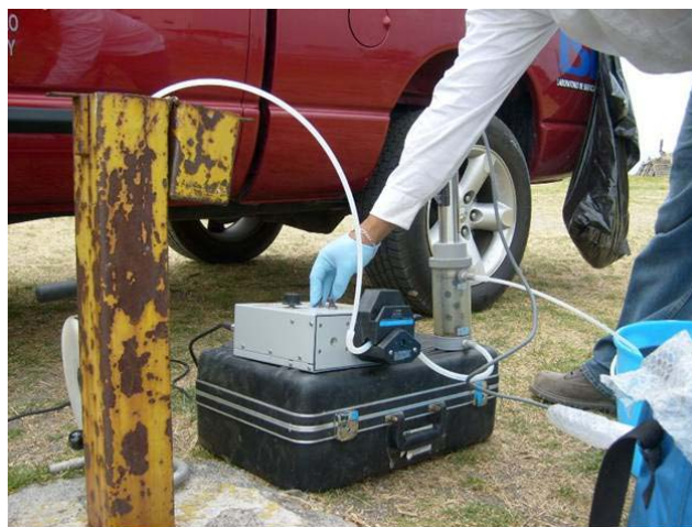
Fotografía 6. Muestreo de método de bajo flujo
