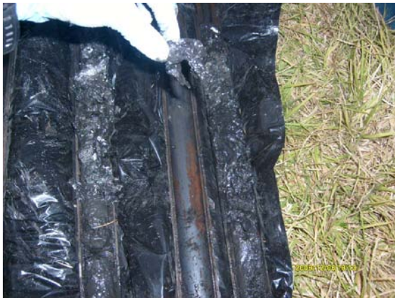
Fotografía 25. Vista del tubo con residuos plásticos en el sondeo SDN-5.
