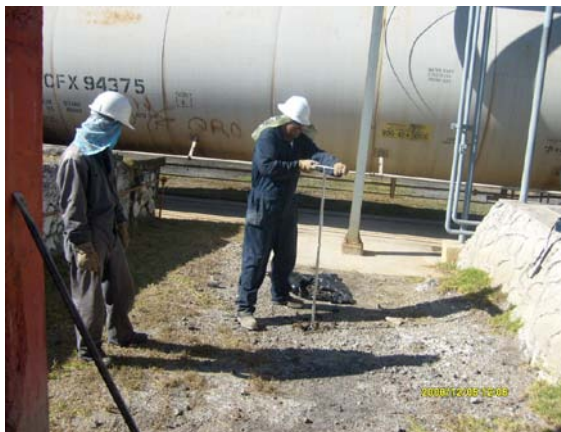
Fotografía 17. Muestreo de suelo en el sondeo STD-4
