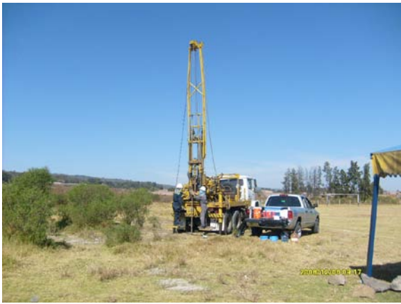
Fotografía 21. Muestreo de suelo en el sondeo SDN-2
