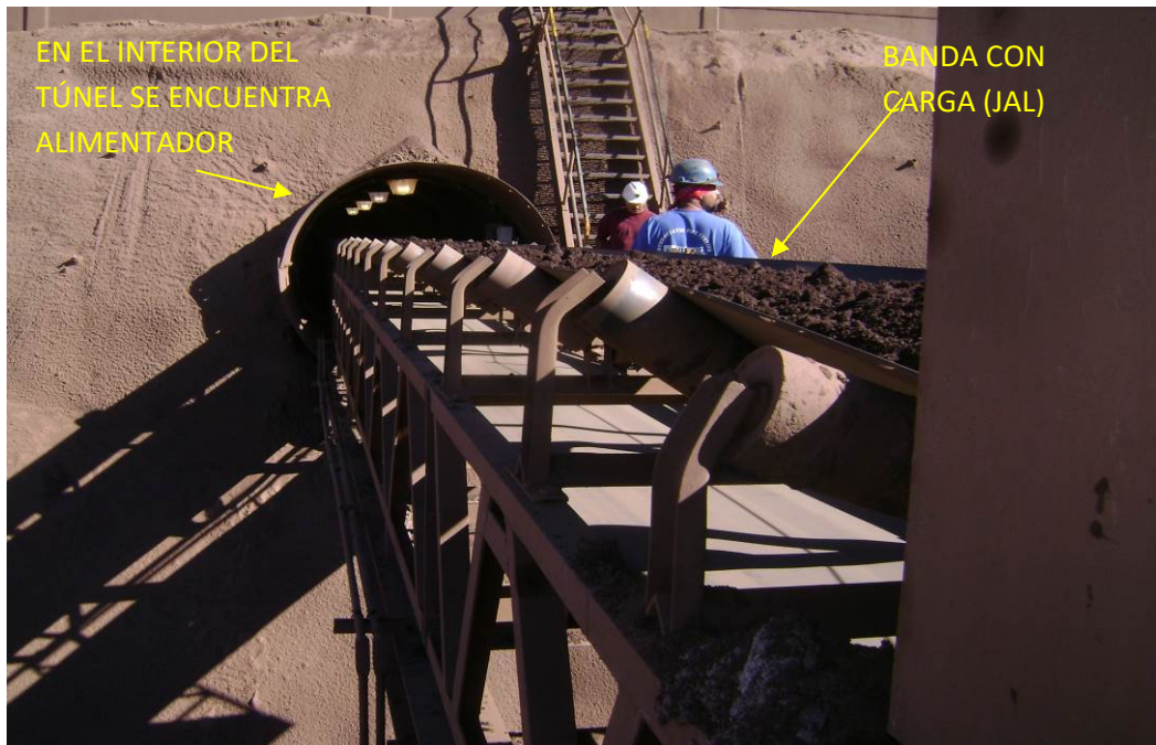
Figura 36 Banda transportadora capacidad de 220 ton por hora.
