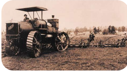
Figura 1.1 Caldwell Vale, tractor australiano (1910). Direccionamiento y tracción en las cuatro ruedas.
